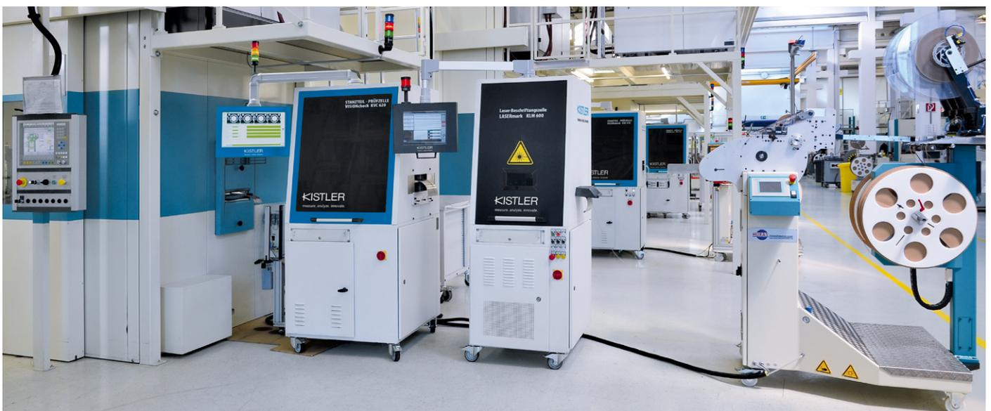
Bild 7: Mit einem Lasermarkierungssystem von Kistler wie dem abgebildeten KLM 621 können bis zu 2.500 Teile pro Minute mit einer Beschriftung versehen werden.
