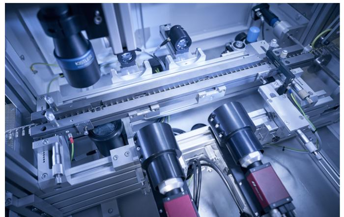
Bild 3: Eine Stanzteilprüfzelle mit dem integrierten Verfahren „Shape from Shading“.
