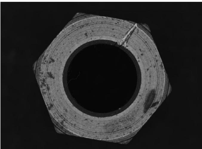
Bild 1: Texturbilder lassen keine sichere Aussage über mögliche Fehler zu, denn diese sind eventuell nicht sichtbar. Zudem stören Farb- oder Helligkeitsunterschiede eine stabile Auswertung.
