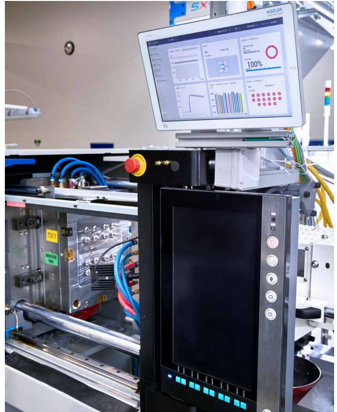
ComoNeo von Kistler, integriert in eine Spritzgießmaschine bei EVCO: Mit der MULTIFLOW-Funktion können Mehrkavitätenwerkzeuge auf Basis präziser Werkzeuginnendruckmessungen gesteuert und überwacht werden.
