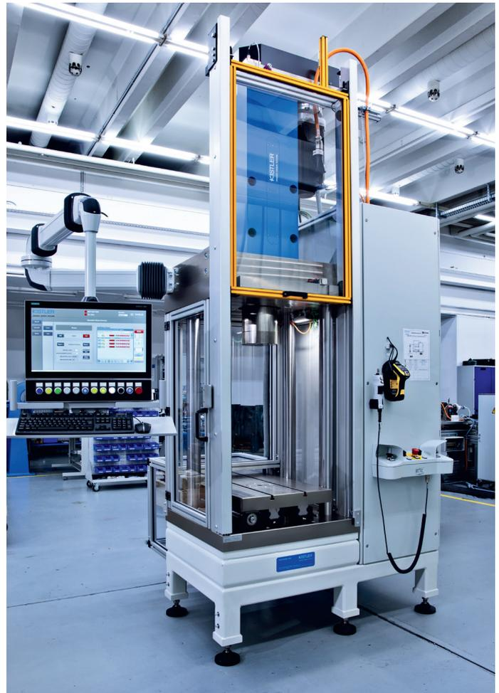
Smart Single Station von Kistler als Handarbeitsplatz zum Einpressen von Rotorpaketen mit hoher Fügekraft – ausgestattet mit verfahrbarem Tisch, Sicherheitstür, Handscanner und IPC
