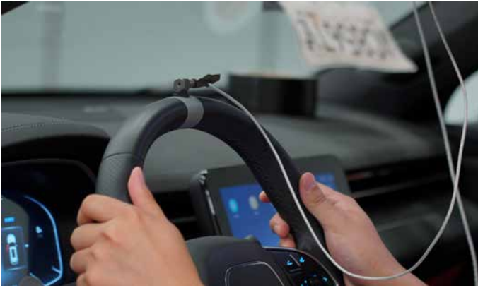
Ein Beschleunigungssensor 8763B von Kistler ist auf einem Lenkrad montiert: NVH-Test am China Automotive Engineering Research Institute (CAERI) in Chongqing.
