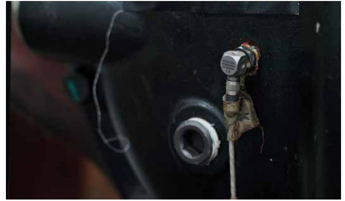
Für NVH-Analysen von Antriebssträngen, Komponenten und Hilfssystemen vertrauen die Ingenieure von CAERI auf Kraft- und Beschleunigungssensoren von Kistler – hier der keramische Miniatur-IEPE-Sensor 8763B.
