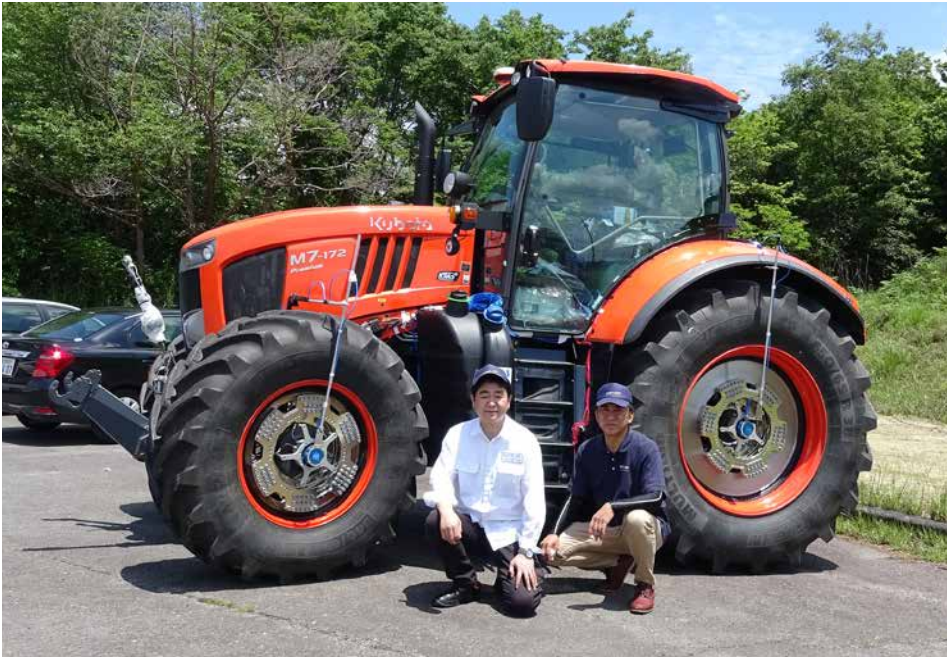
クボタのトラクターの前で、キスラー セールスエンジニアの藤倉透氏(左)とキスラー セールスセンター日本代表の開悟氏(右)：測定には、キスラーのRoaDyn S6XT輪力変換器が使用された。
