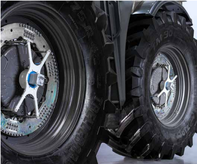
Auch das größte Messrad von Kistler, RoaDyn S6GT, wird bei Kubota für die Weiterentwicklung von Traktoren zum Einsatz kommen.
