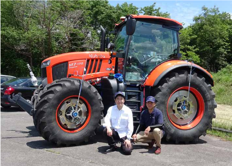
Toru Fujikura, Vertriebsingenieur bei Kistler (links) und Satoru Hiraki, Head of Kistler Sales Center Japan (rechts), vor einem Traktor von Kubota: Für die Messungen wurden Messräder RoaDyn S6XT von Kistler eingesetzt.
