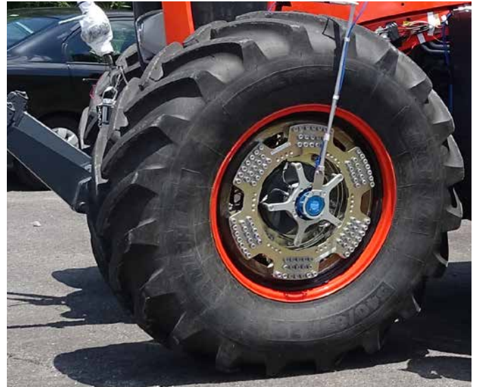
Zur optimalen Nutzung des Radkraftsensors RoaDyn S6XT stellte Kistler für Kubota spezielle mechanische Adaptionen für verschiedene Traktortypen und Montagebedingungen zur Verfügung.
