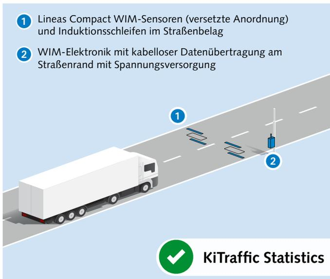
WIM-System für die Analyse der Verkehrsbelastung
