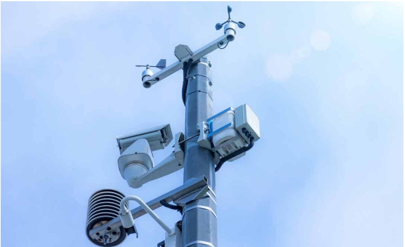
Automatische Wetterstation mit Wetterüberwachungssystem und Beobachtungskameras
