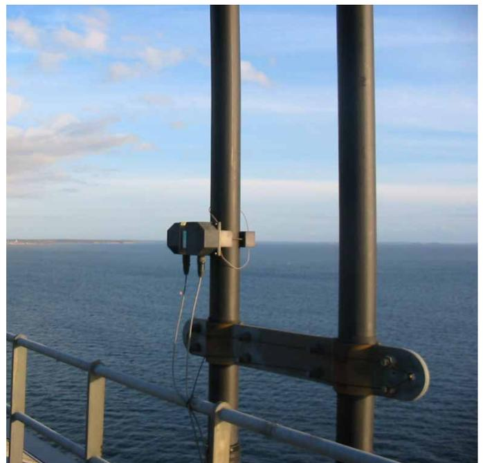
Das Messsystem (inkl. Beschleunigungssensoren, Filtern und Signalübertragung) an den vertikalen Tragseilen wurde in speziellen Boxen installiert, um robust gegenüber rauen Wetterbedingungen über lange Zeit zu sein.
