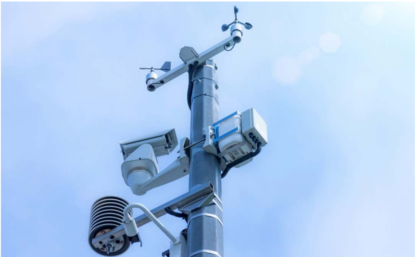
Automatische Wetterstation mit Wetterüberwachungssystem und Beobachtungskameras
