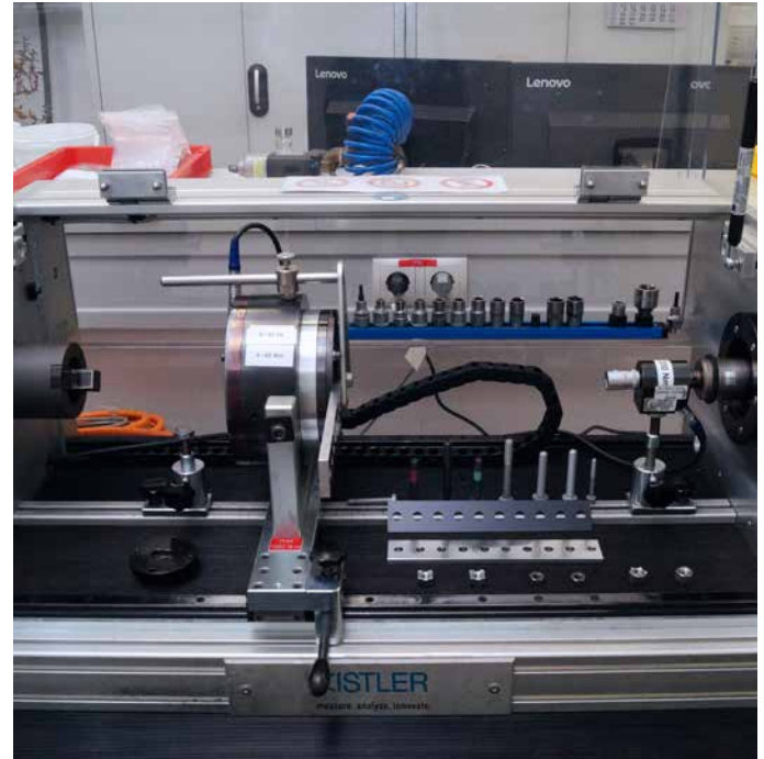
Der Laborprüfstand zur präzisen Ermittlung von Reibungszahlen: Das ANALYSE System von Kistler ist modular aufgebaut und kann mit mehreren Antrieben sowie einem Vibrationsprüfstand ausgerüstet werden.
