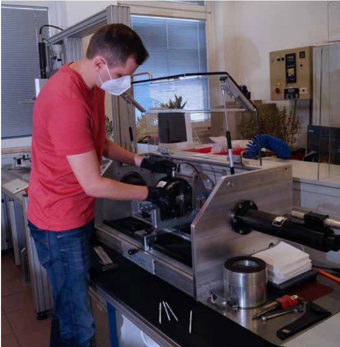
Ein ANALYSE System von Kistler – hier bedient von Qualitätstechniker Eduard Buch – ist im Labor am Hauptsitz von Dörken fast täglich für die Reibungszahlermittlung im Einsatz.
