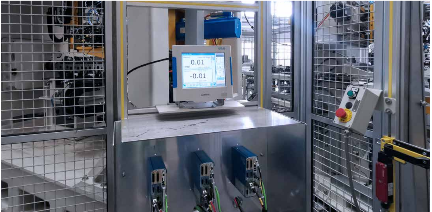
Drei Prozessüberwachungssysteme maXYmos NC mit zugehörigem Anzeigemodul steuern Fügesysteme von Kistler beim südchinesischen Motorenhersteller Yuchai.
