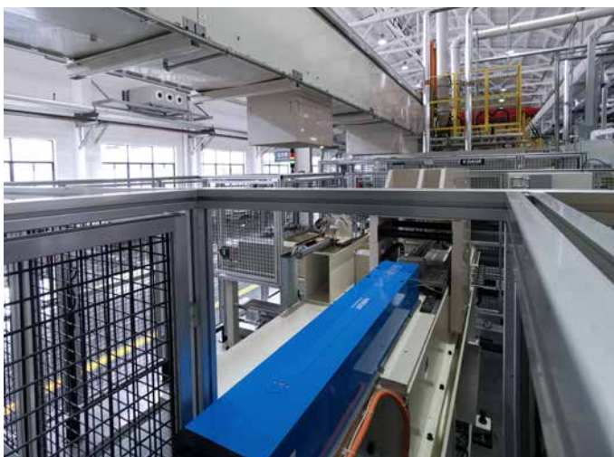
Das elektromechanische Fügесystem NCFN von Kistler wurde für den Motorenhersteller Yuchai in Yulin (China) kundenspezifisch ausgelegt mit einem sehr langen Hub von 1.000 mm.
