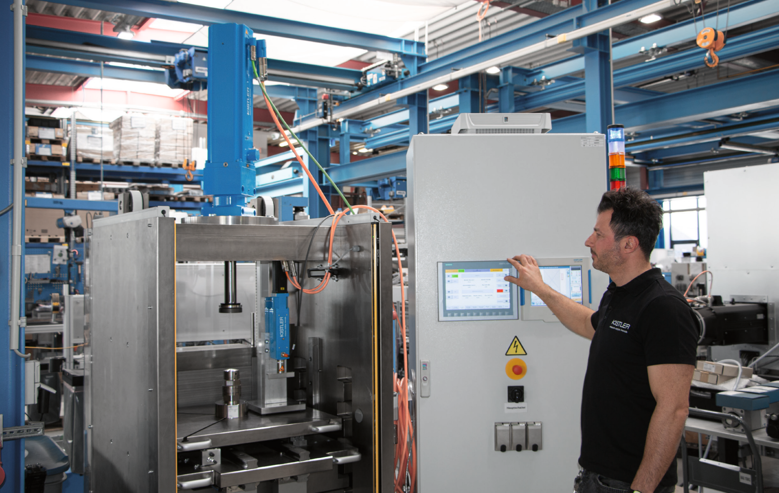
Versuchsarbeitsplatz von Kistler bestehend aus Gestell, NC-Fügemodul sowie Schaltschrank mit Messtechnik, Steuerung und Datenerfassung
