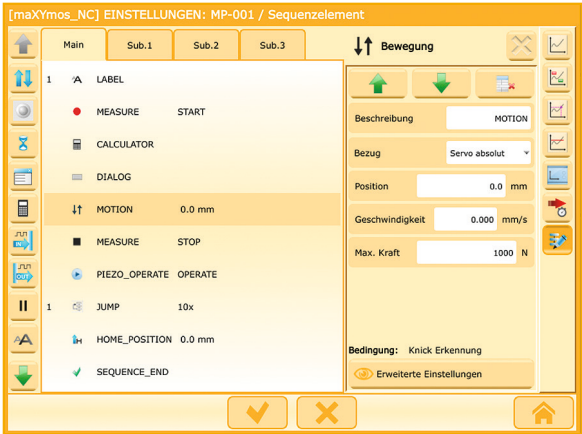
Für jedes der bis zu 128 Programme besteht die Möglichkeit, einen unabhängigen Ablauf zu definieren.
