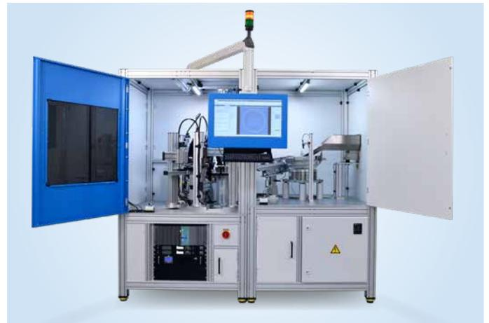
Neun Prüfautomaten der neuen Generation KVC-821 von Kistler sind bei Zinktechnik AB integraler Teil einer hochautomatisierten Null-Fehler-Produktion von Zinkgussteilen in großen Stückzahlen.
