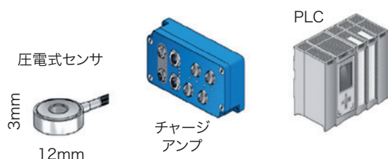
図 5: チャージアンプとプログラマブルロジックコントローラを組合わせた圧電式力センサ
