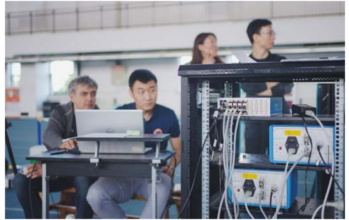
Volle Konzentration auf den Sprung: Messplatz mit Auswerteelektronik für die Kraftmessplatten von Kistler
