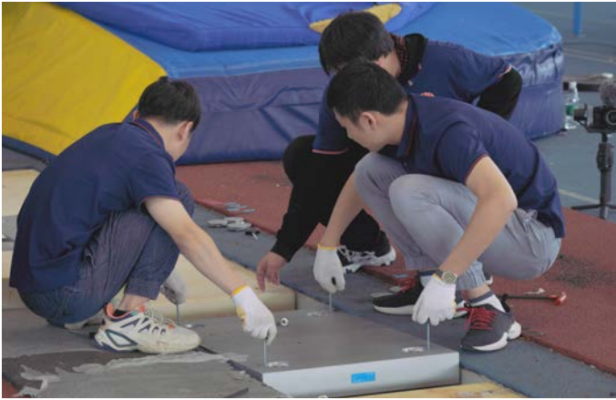
Um den Anlauf jedes Stabhochspringers (besonders die letzten drei Schritte) exakt zu vermessen, können die Kraftmessplatten von Kistler mit wenigen Handgriffen neu positioniert werden.
