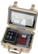
Alle Komponenten wie z.B. Kameras, Sensor und Bedien-Laptop werden sicher per WLAN untereinander verbunden. Der WLAN-Router wird in einem robusten und wetterfesten Koffer transportiert und mit einem 2 kg leichten Akku betrieben.
