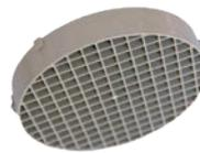
Der Quadratfilter für die Blitzeinheit BE 1.3 wird auf das Außengewinde der Blitzeinheit aufgesteckt und bewirkt, dass der nachfolgende Verkehr die Blitzauslösung deutlich geringer wahrnimmt. Zudem wird ein Reflektieren der Rotfilterscheibe durch Sonneneinstrahlung verhindert.
