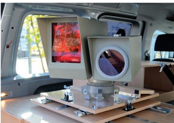
5 Flexibler Schlitten zum Fotografieren aus dem Fahrzeug
