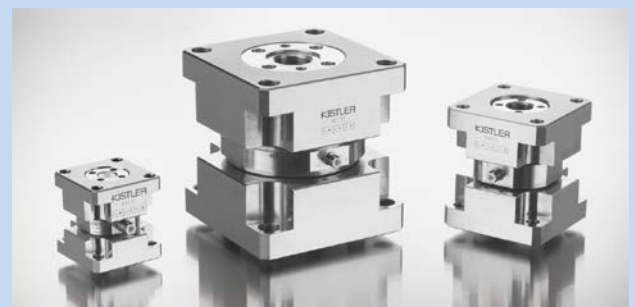
Der Kraftsensor 9377C von Kistler ist ein piezoelektrischer, vorkalibrierter 3-Komponenten-Kraftaufnehmer für Kräfte von bis zu 150 kN.
