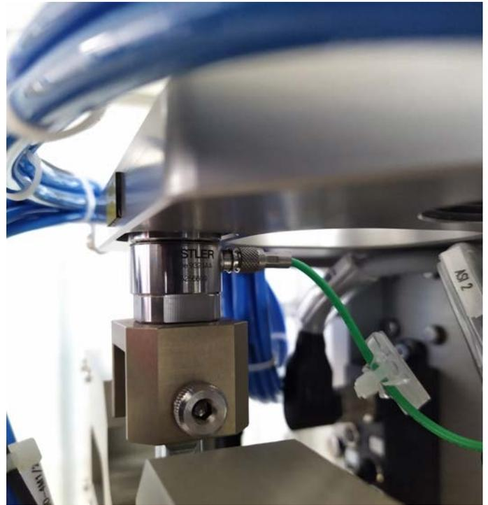
Kistler 9323AA压力传感器监控药物插入步骤和驱动模块重新整合到自动注射器中。
