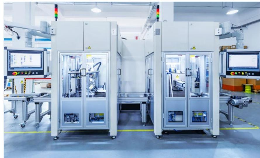
Unsere Prüfstandlösungen werden direkt in die Fertigungslinie des Kunden integriert und bieten eine modulare Vielfalt an Tests für Elektromotoren und weitere antriebstechnische Komponenten.
