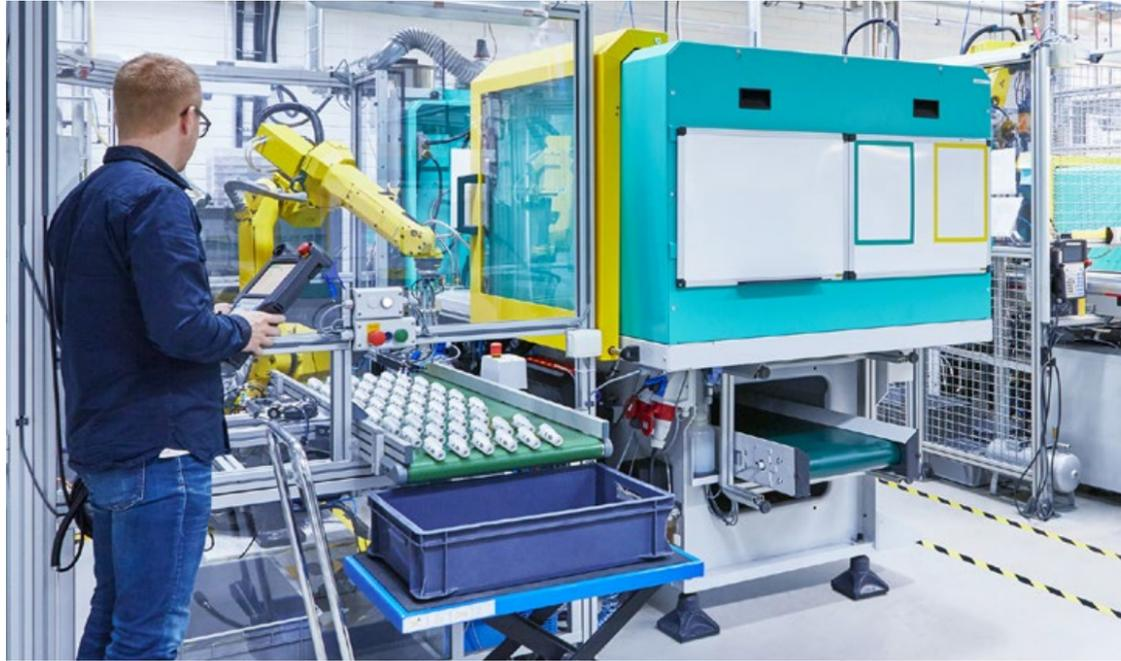
Die im Werkzeug verbaute Sensorik liefert die Basis für alle stofflichen und formteilspezifischen Bauteilattribute und somit den „Fingerabdruck“ des Bauteils.
