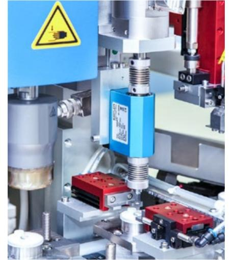
Der integrierte Drehmomentsensor von Kistler sorgt für eine Funktionsprüfung am Bauteil und kommuniziert direkt mit der Steuerung bei einer Zykluszeit von nur 1,5 Sekunden.
