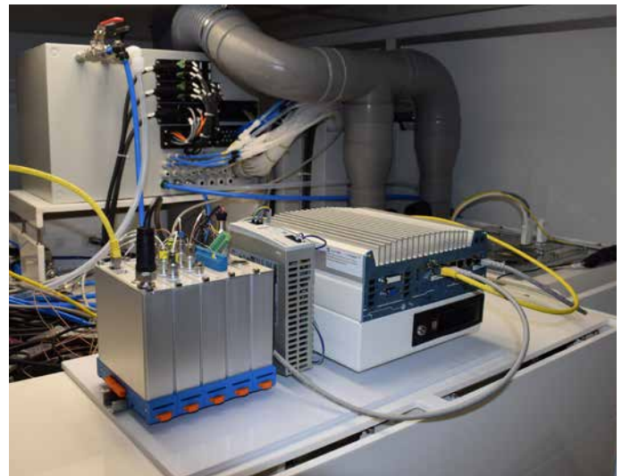
Das Datenfassungssystem KiDAQ von Kistler (vorne links) ist mit einem IPC (vorne rechts) verbunden, der die Daten aus der Anlage zunächst lokal zwischenspeichert.
