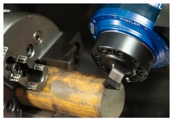
森拉天时采用9171A型四分量旋转式切削测力计(RCD)测量切削力。压电传感器技术赋予RCD超高采样率和灵敏度,以及极宽的力测量范围。
