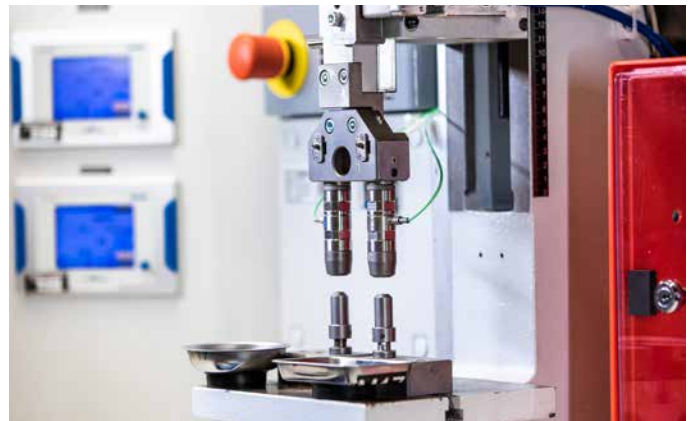
Zwei Force-Link Sensoren 9340A von Kistler überwachen die beim Fügevorgang anliegenden Kräfte.
