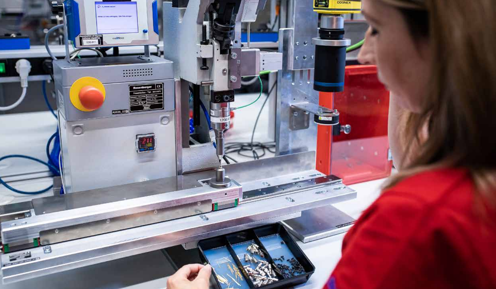
Das Prozessüberwachungssystem maXYmos von Kistler führt die Produktionsmitarbeiterin über das Display durch den Montageprozess.
