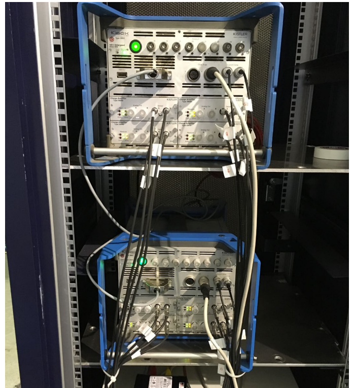
使用2台奇石乐 KiBox级联设备，实现对16个气缸进行同步数据监测和优化。
