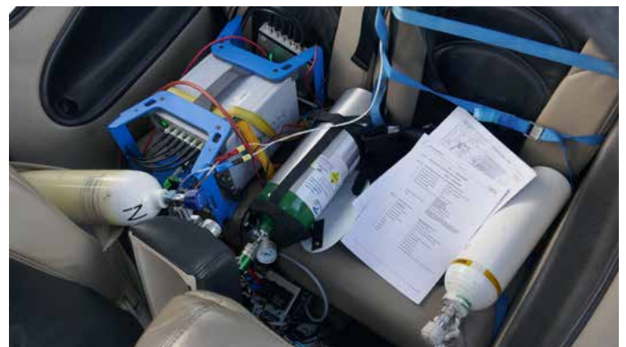
Messplatz im Cockpit, links die KiBox von Kistler für die Motorenindizierung
