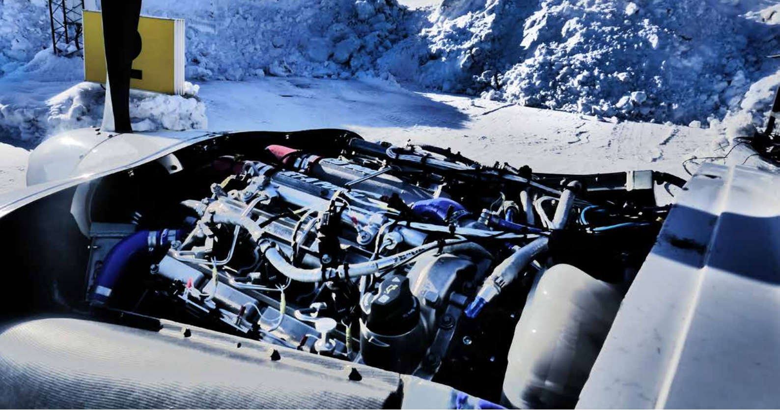
Blick in den Motorraum des Flugzeugs mit dem für die Indizierung mit der KiBox instrumentierten Motor von Continental Aerospace Technologies
