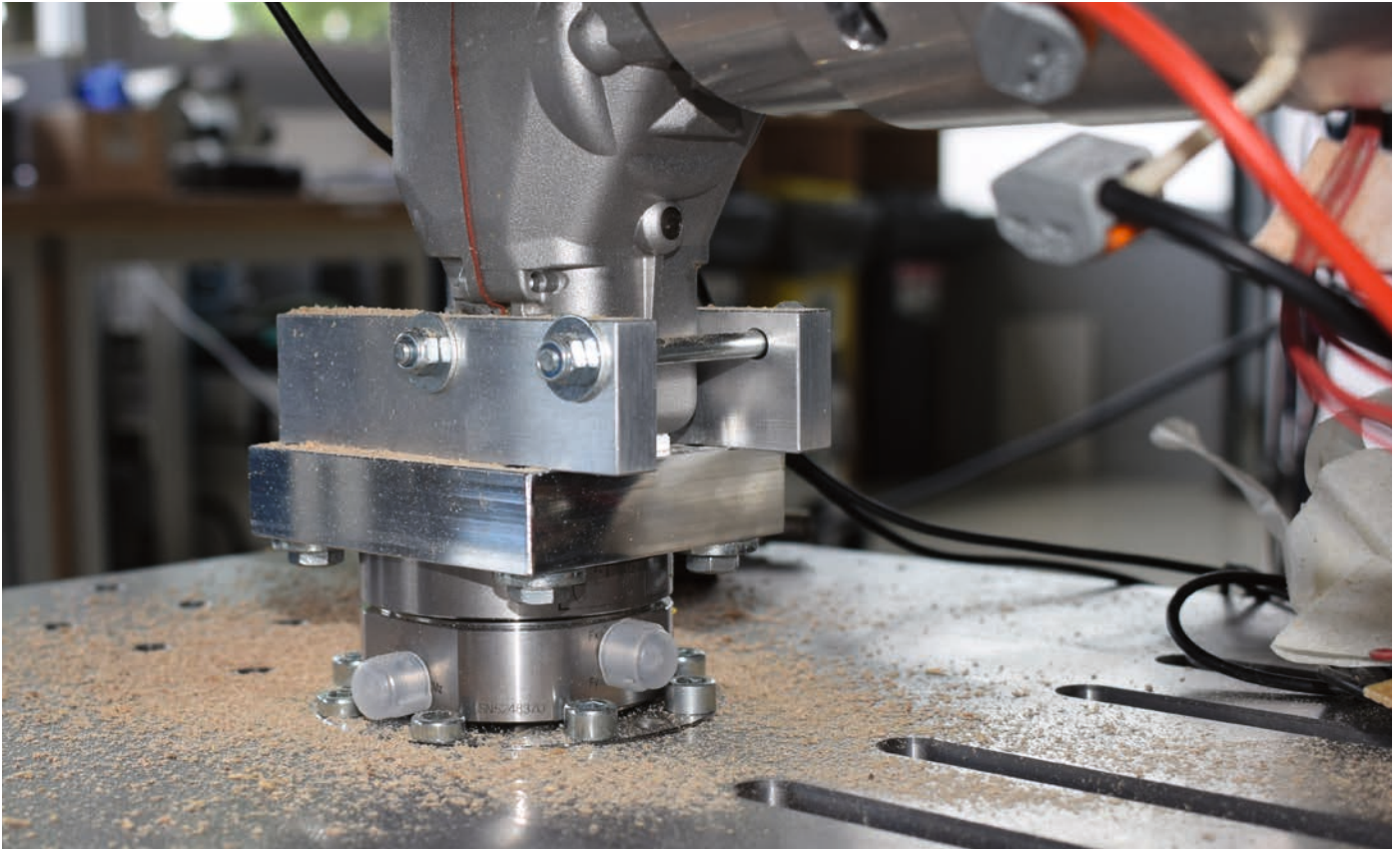
Der 6-Komponenten Kraft-/Momenten-Sensor von Kistler misst exakt die dynamischen Kräfte und Momente, die auf die Stichsäge einwirken. Die Säge ist kopfüber montiert.
