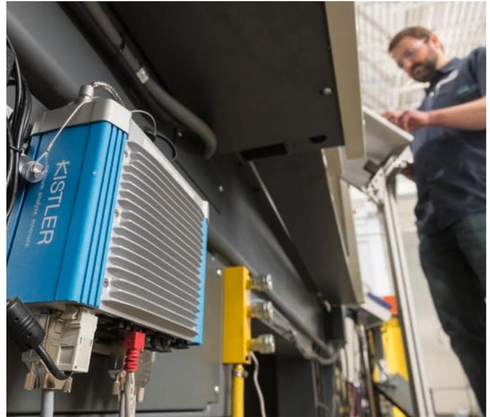
Mit ComoNeo erhält der Techniker detaillierte Informationen über den Verlauf des Werkzeuginnendrucks in Echtzeit. Die Visualisierung auf dem kapazitiven Multi-Touch-Display macht Prozessschwankungen leicht erfassbar.
