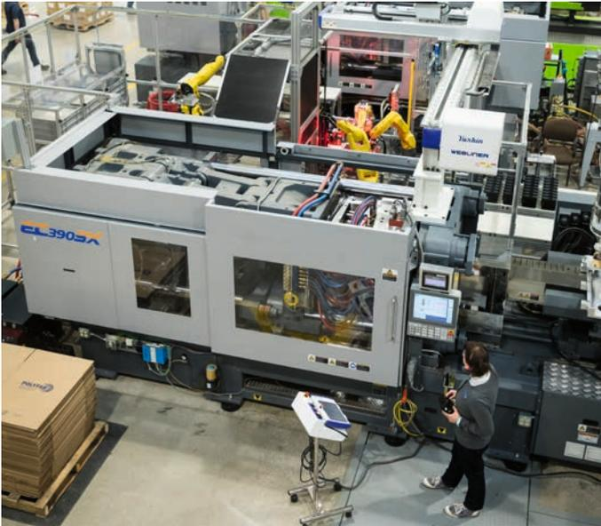
In der hochmodernsten Produktion von Polyfab kommen die Prozessüberwachungssysteme ComoNeo und CoMo Injection sowie Werkzeuginnendruckensensoren von Kistler zum Einsatz.
