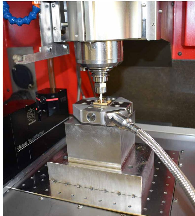
Dank dem MicroDyn von Kistler, dem kleinsten Dynamometer der Welt, können die am Werkzeug auftretenden Schnittkräfte bei bis zu 120 000 U/min präzise gemessen werden.
