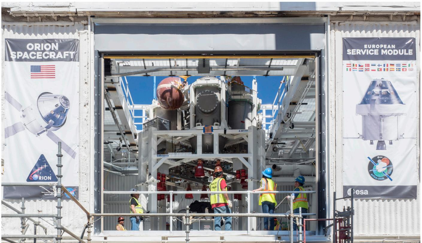
Die NASA baut weitere Komponenten, wie etwa das Haupttriebwerk, in das Testmodul PQM ein und führt Acceptance- und Heißuertests durch, bei denen Sensoren von Kistler essentielle Informationen liefern.
