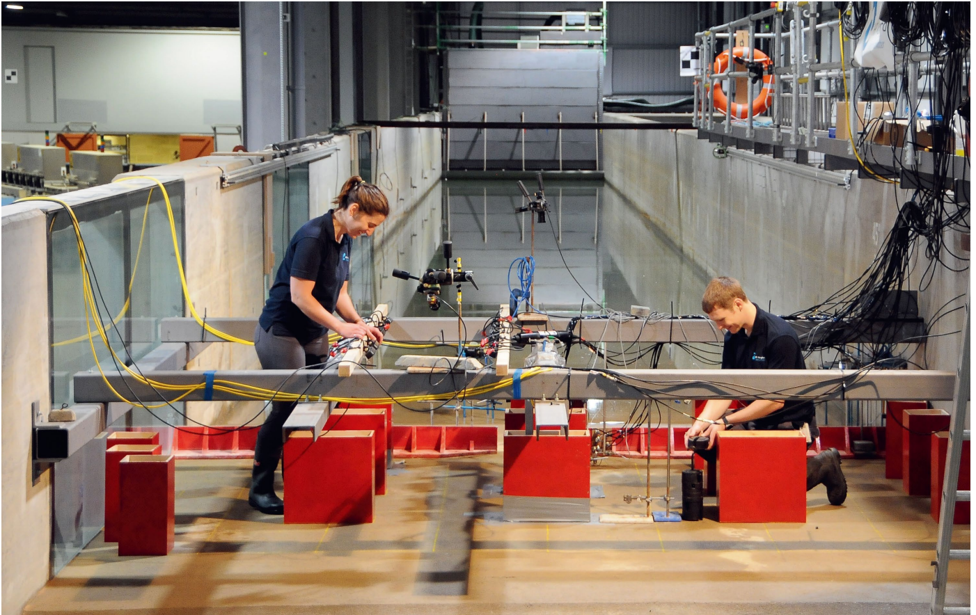
英国小镇沃灵福德拥有一处欧洲最大、流速最快的波浪水槽；在此处，可以1:50的比例模拟海啸。 (来源：英国水力研究院 (HR Wallingford) )
