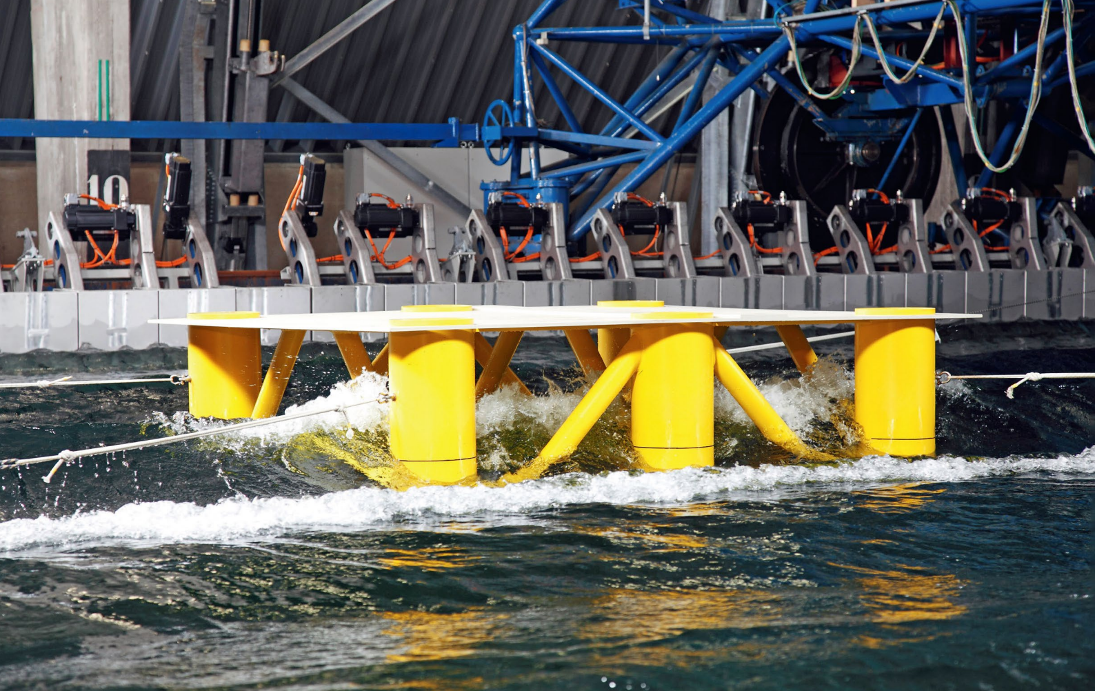
正在油气平台模型上实施的拍击测试（来源：德国汉堡船模实验室（HSVA））
