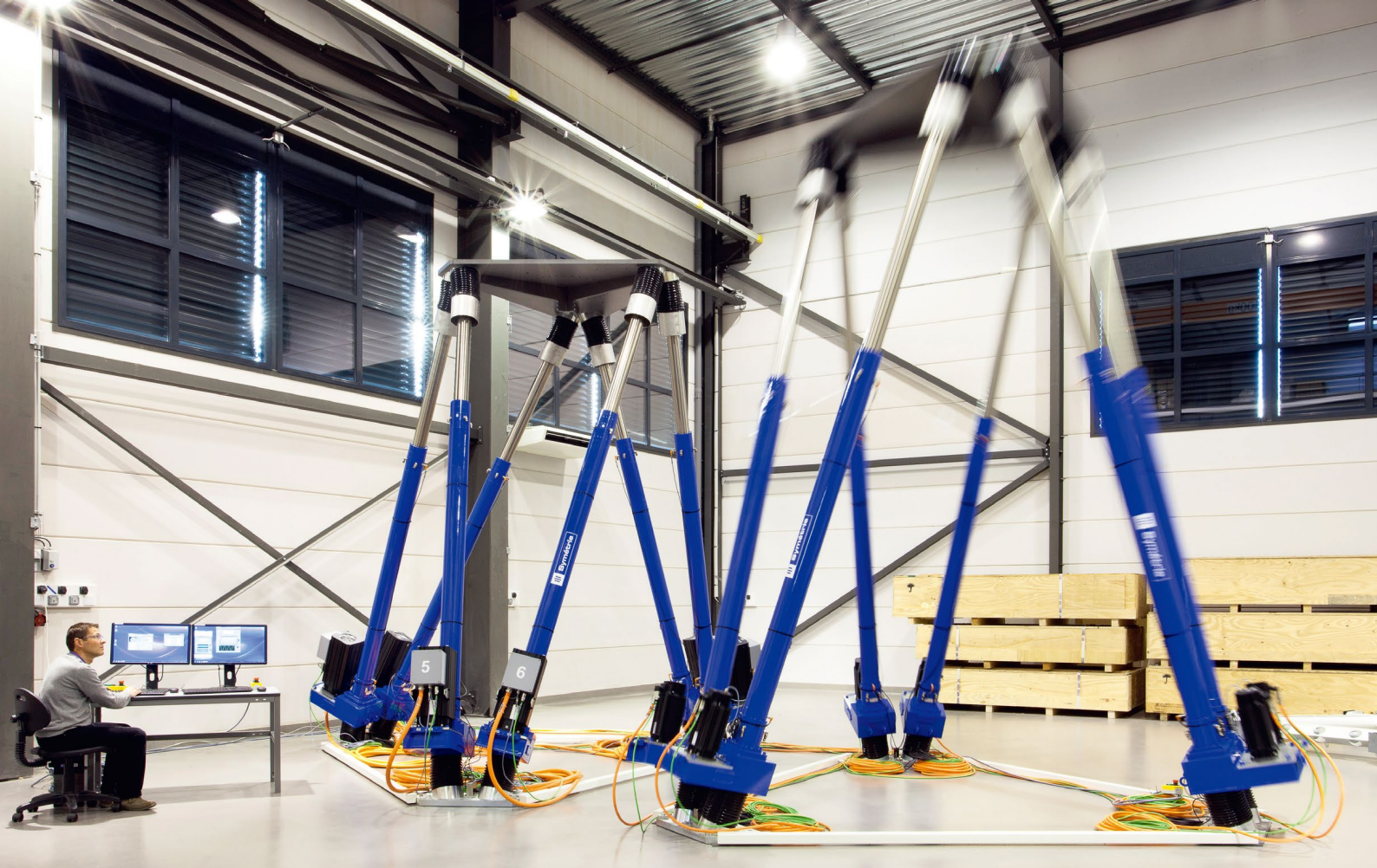
利用安装在hexapod台架顶部的液化天然气罐体模型构建的晃动模拟系统（来源：Symétrie）
