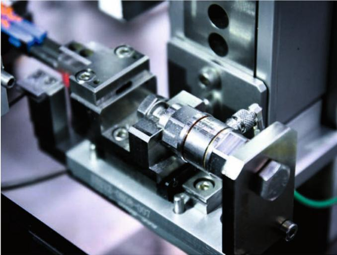
Mit den integrierten Sensoren von maXYmos wird die fertige Komponente überprüft.
