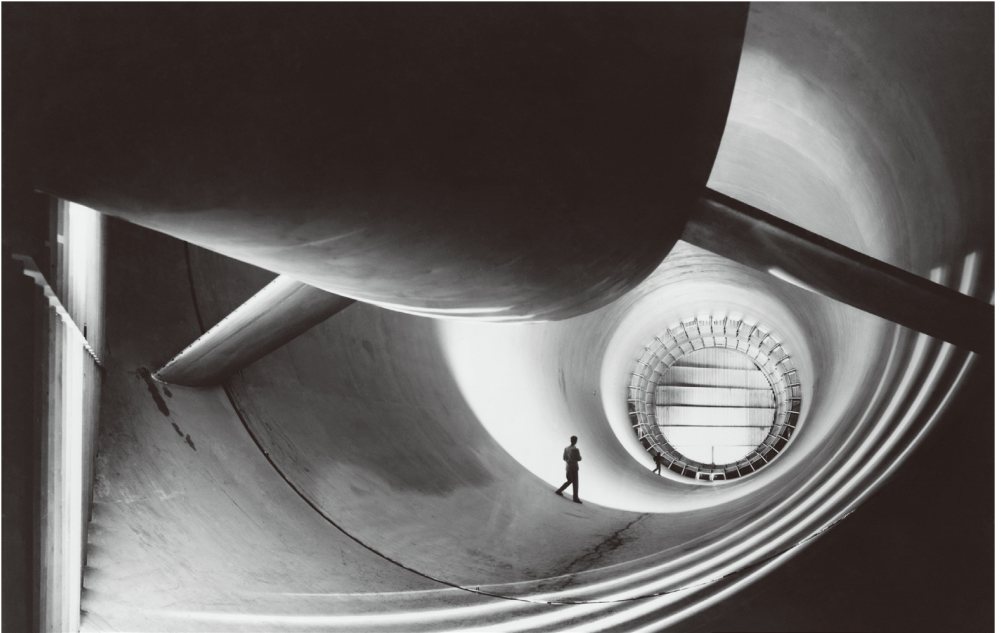
风洞是用于空气动力学研究的工具，用于研究空气移动经过固态物体的影响。
