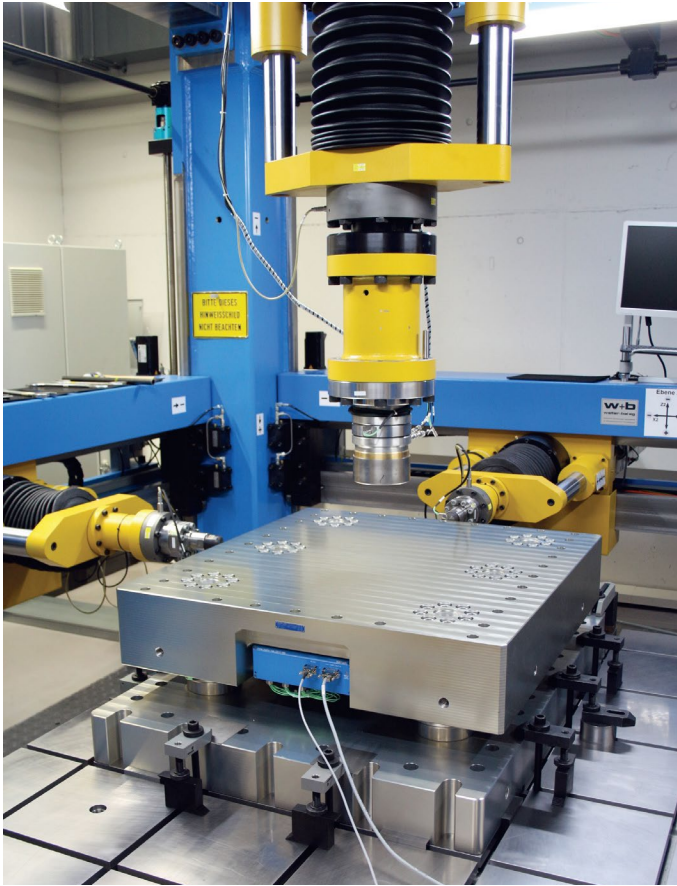
校准定制的力测力计，用于奇石乐特殊的三维校准装置的起落架跌落测试。
