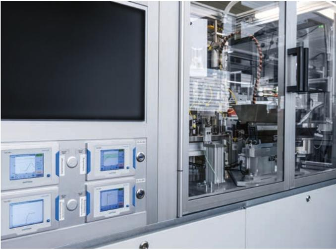
Pro Stunde werden etwa 3 000 elektrische Sicherungen mit der neuen Anlage gefertigt. Im neuen Vollautomaten von Schurter und ROBO • MAT sind vier Prozessüberwachungssysteme maXYmos BL von Kistler installiert (links im Bild)
