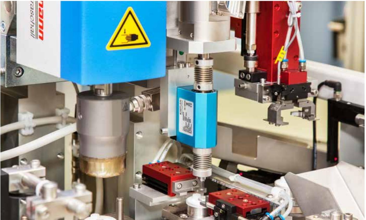
Der Drehmomentsensor von Kistler sorgt für eine integrierte Funktionsprüfung am Bauteil und kommuniziert direkt mit der Steuerung bei einer Zykluszeit von nur 1,5 Sekunden.
