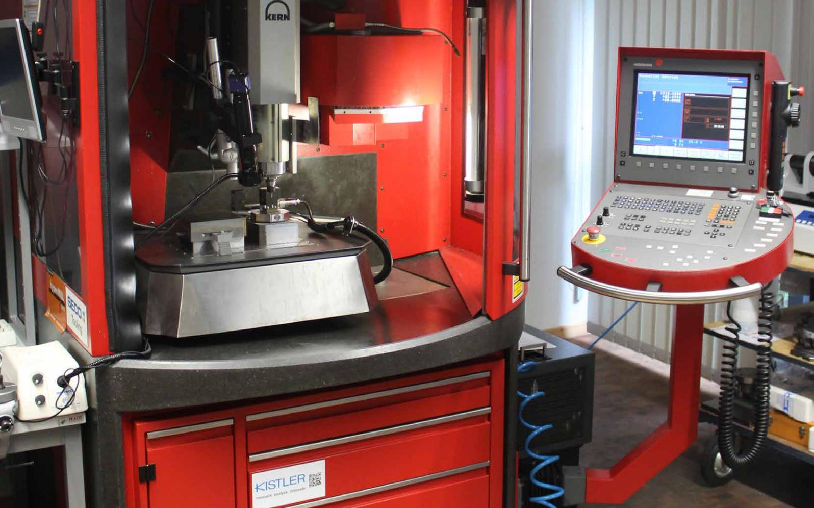
Am Mikrobearbeitungszentrum KERN HSPC 2522 werden Zerspanungsuntersuchungen mit Kleinwerkzeugen durchgeführt
