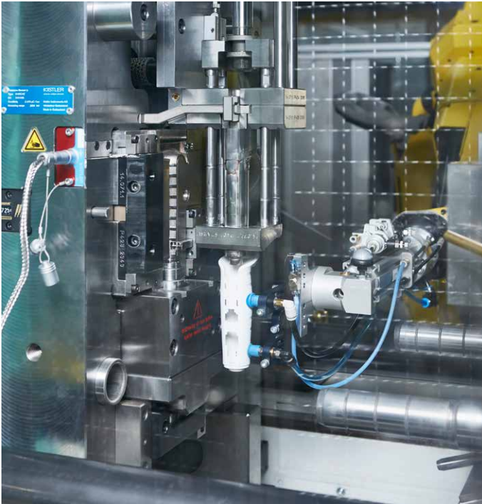
Die im Werkzeug verbaute Sensorik liefert die Basis für eine transparente Prozessführung für alle stofflichen und formteilspezifischen Bauteilattribute und ist somit der Fingerabdruck des Bauteils
