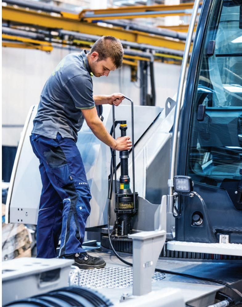
Liebherr 社のナットランナ「LTM 1160-5.2」で旋回輪を締付ける作業：
