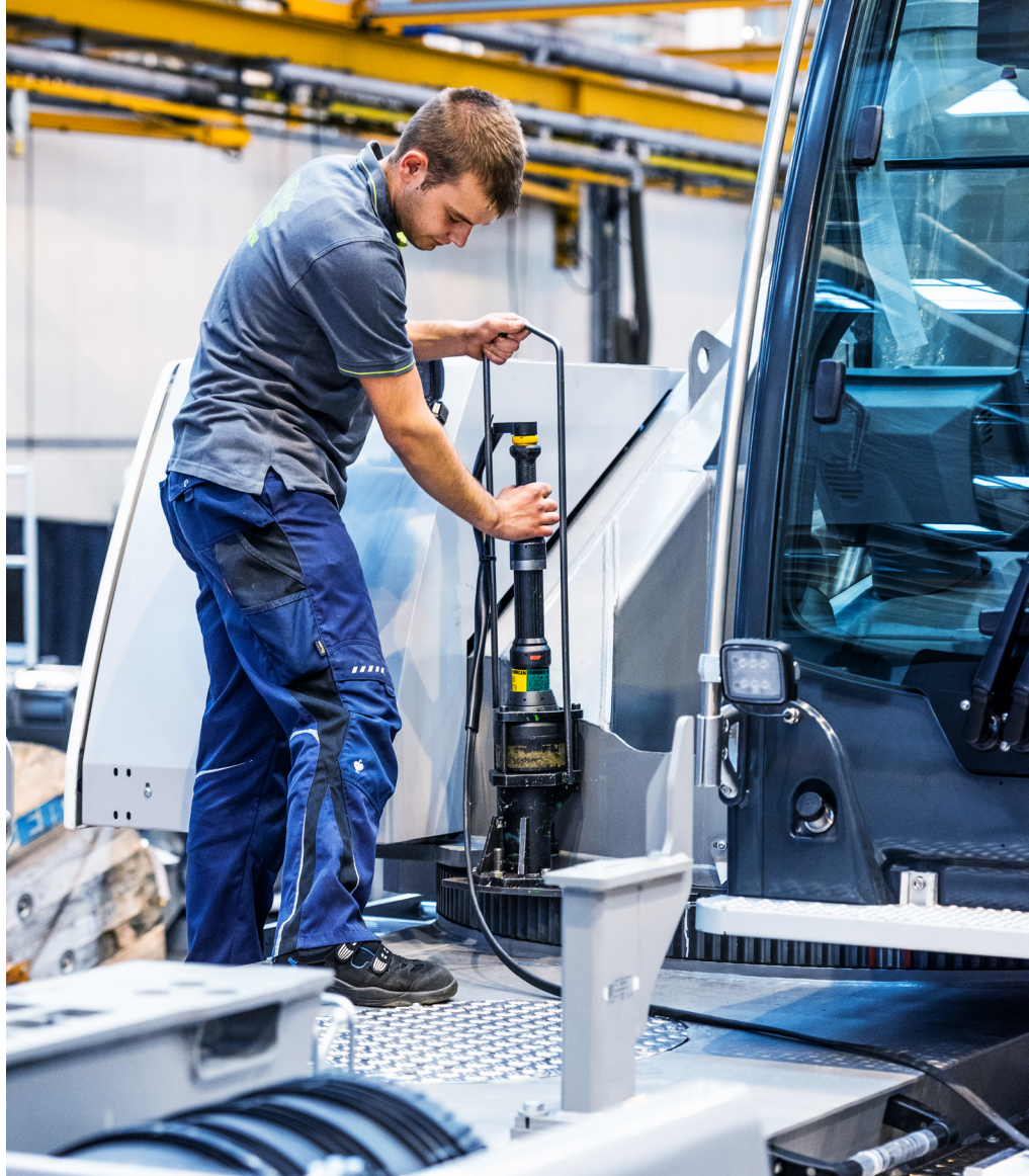
Verschraubung Drehkranz am Liebherr LTM 1160-5.2, Schrauber Atlas Copco ETD59-2000-38-CTADS
