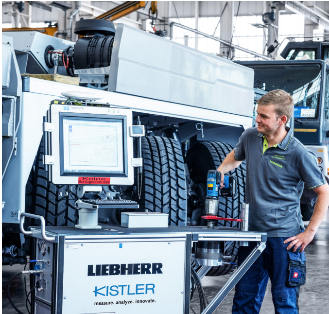
Schraubstellenbezogene Prüfung am Liebherr LTM 1450-8.1
