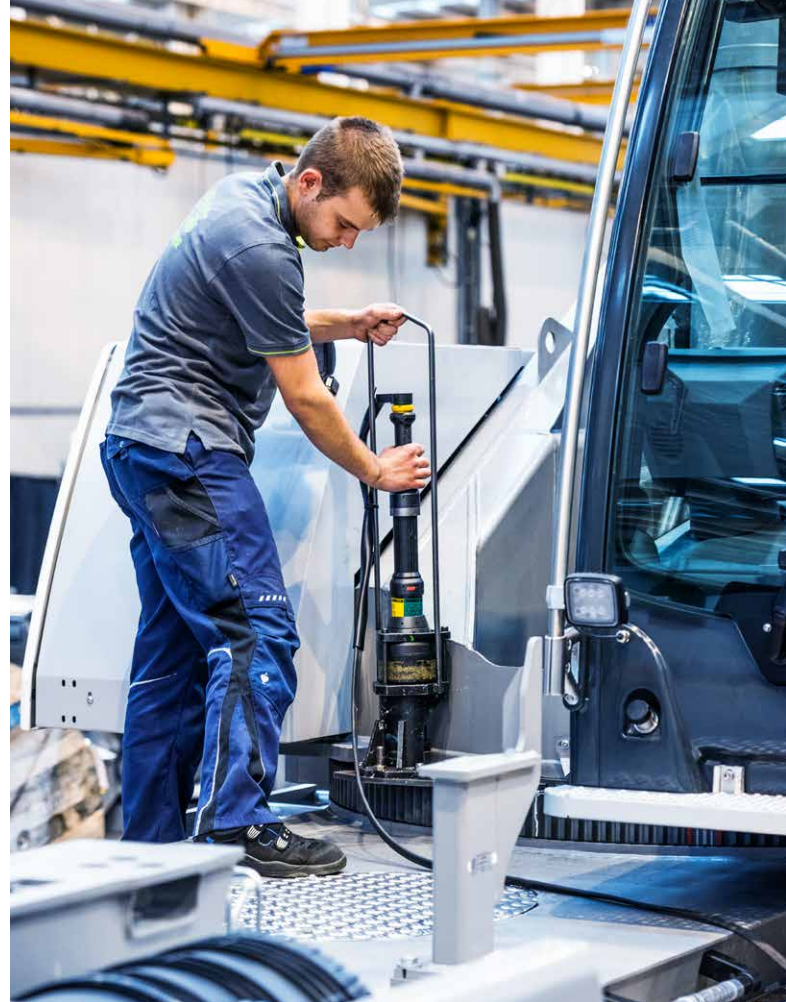
Verschraubung Drehkranz am Liebherr LTM 1160-5.2, Schrauber Atlas Copco ETDS9-2000-38-CTADS
