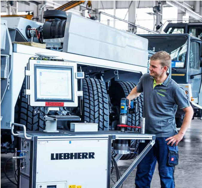
Schraubstellenbezogene Prüfung am Liebherr LTM 1450-8.1
