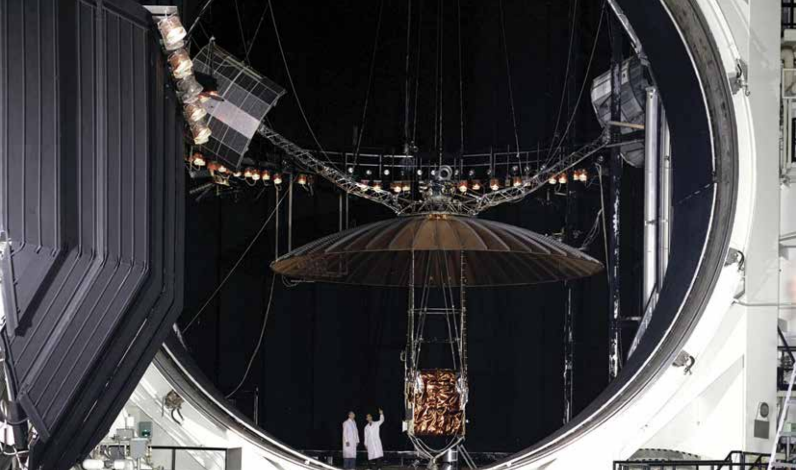
Satelliten-Umgebungsprüfung in der thermischen Vakuumkammer
