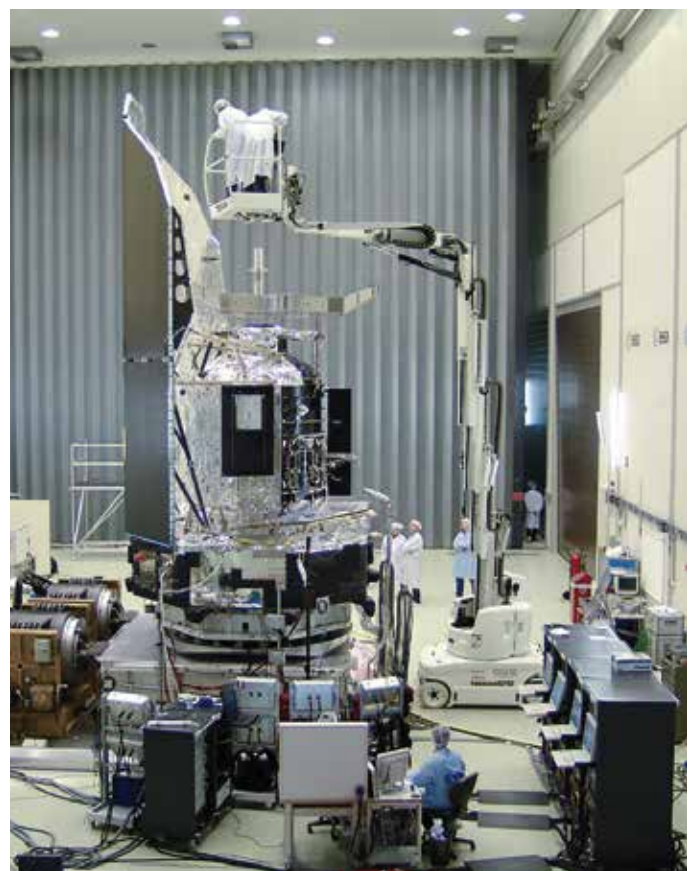
Umwelt- und bodengebundene Tests der Weltraumstruktur (Quelle: ESA)
