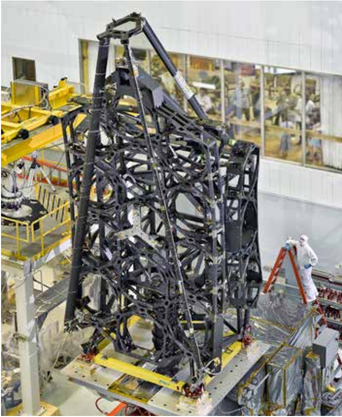
Das James Webb Weltraumteleskop der NASA wird für die Durchführung von thermischen Vakuumtests vorbereitet (Quelle: NASA/Chris Gunn)
