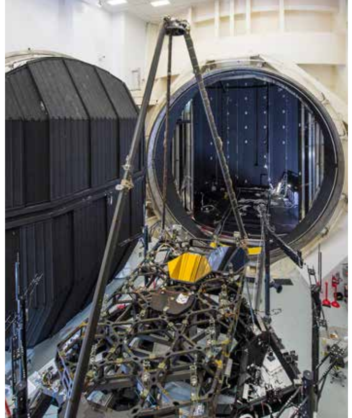
Das große James Webb-Pathfinder-Weltraumteleskop (Backplane-Testversion) wird in die riesige Kammer A im NASA Johnson Space Center für kryogene Tests eingeführt (Quelle: NASA/Chris Gunn)
