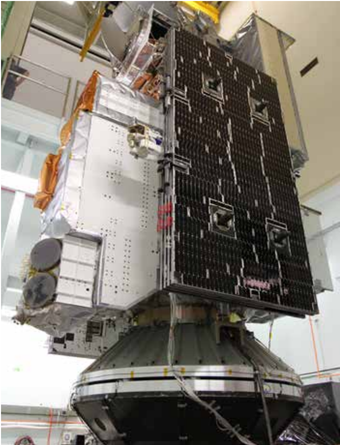
Satelliten-Umgebungsvibrationstests mit Sinus- und Rauschanregung (Quelle: NASA)
