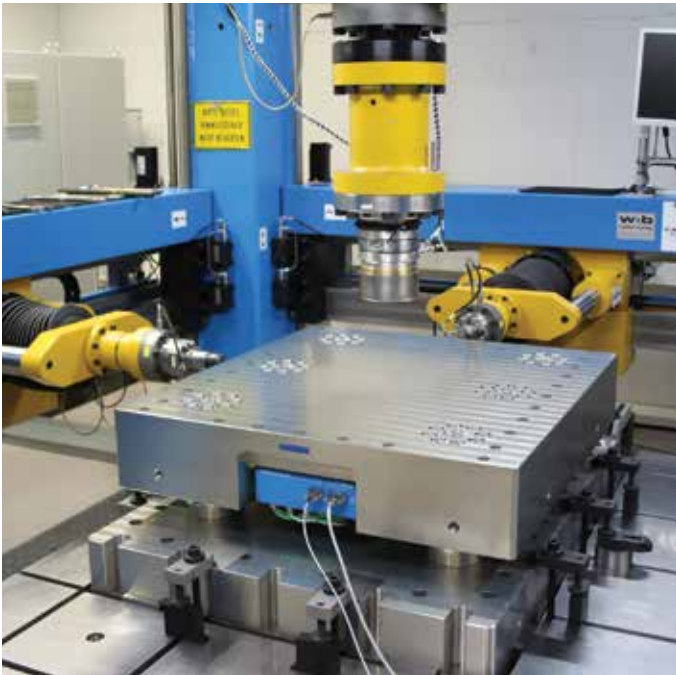
Werkseitige Kalibrierung auf unserer einzigartigen 3-Komponenten-Referenzkraftpresse
