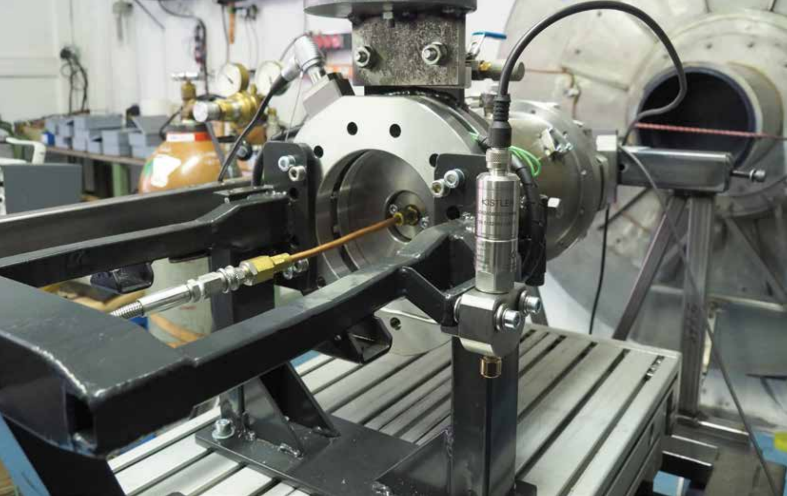
Piezo-resistiver-Drucksensor Typ 406xA zur Überwachung und Steuerung von Treibstoffdrücken (Quelle: SPL)
