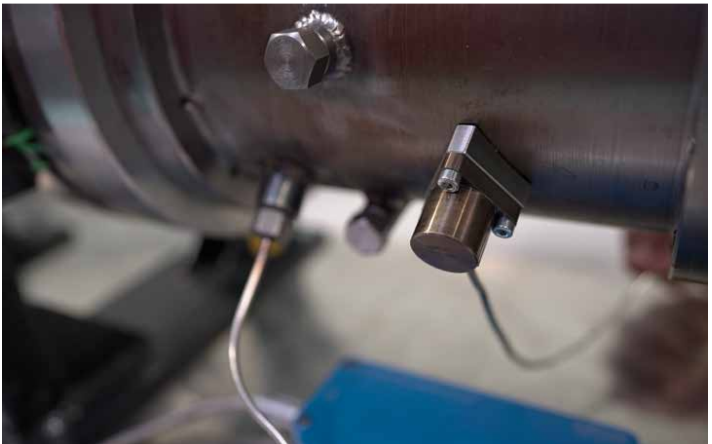
Bei Untersuchungen von Verbrennungsinstabilitäten werden Hochtemperatur-Sensoren Typ 6021A zur Druck- und Typ 8209A zur Beschleunigungsmessung eingesetzt
