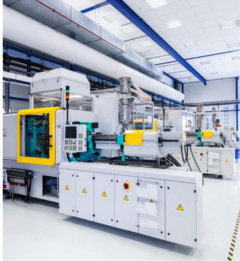
Die hochmodernen Spritzgießanlagen arbeiten mit Werkzeugen mit bis 96 Kavitäten und dem Prozessüberwachungssystem ComoNeo von Kistler
