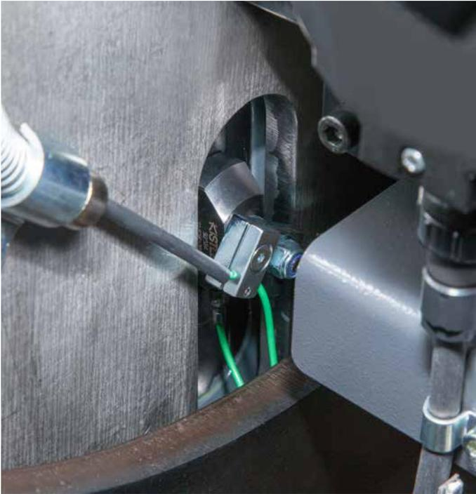
Die Dehnungssensoren von Kistler sind robust und störungsresistent und können einfach montiert und nachgerüstet werden
