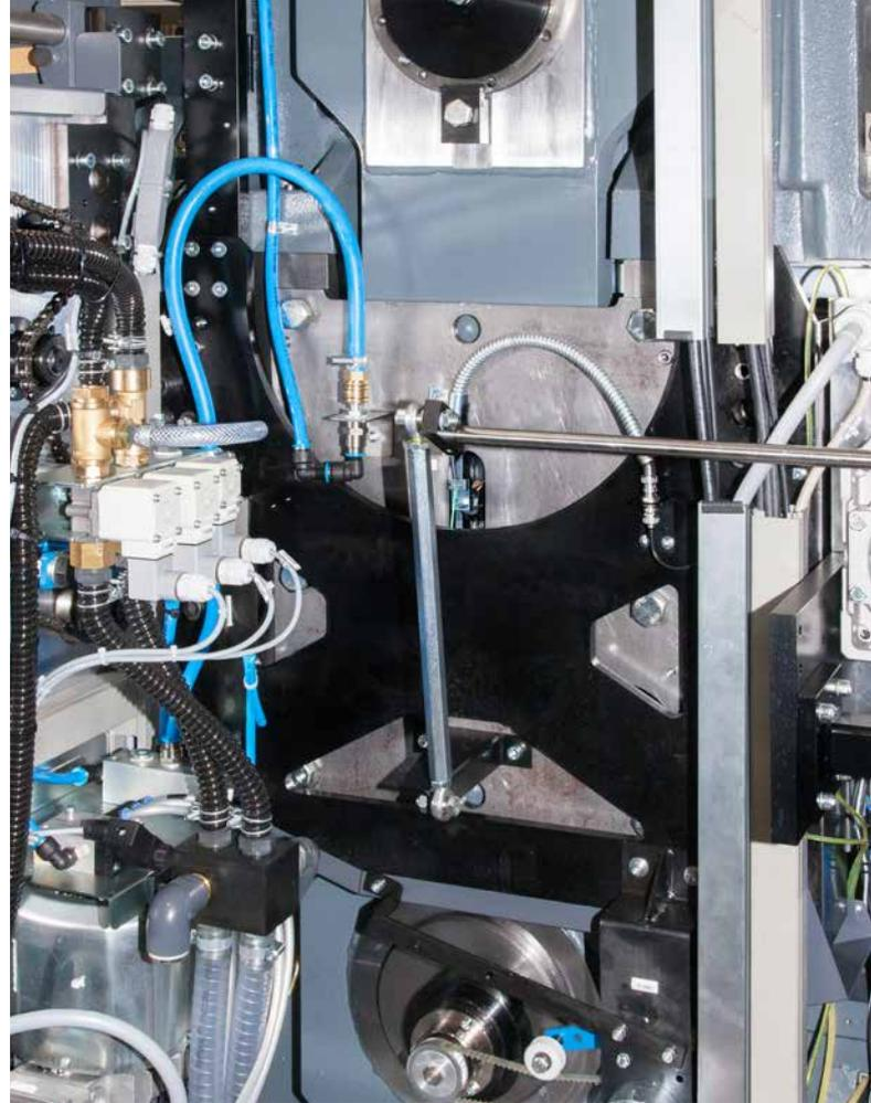
Um ein „Festgehen“ der Maschine zu vermeiden, überwachen Dehnungssensoren von Kistler die aufgewendete Kraft und den Prozessverlauf
