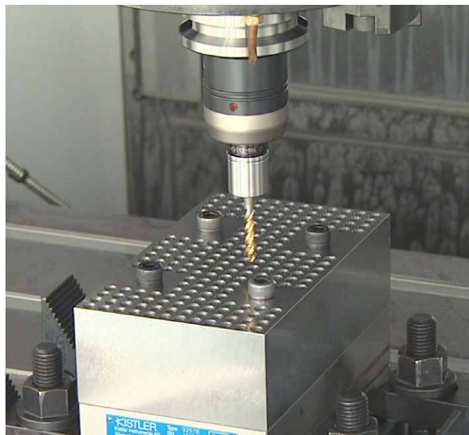
该MEGA Synchro攻丝刀柄采用奇石乐的9257B测力仪研发而成。
