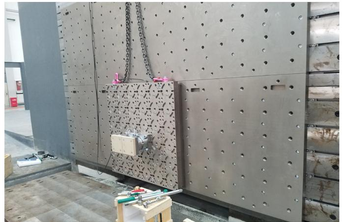
Nach einer mehrwöchigen intensiven Engineering-Phase konnten die Messtechnikexperten von Kistler eine Crashwand mit insgesamt sechs Segmentplatten entwickeln
