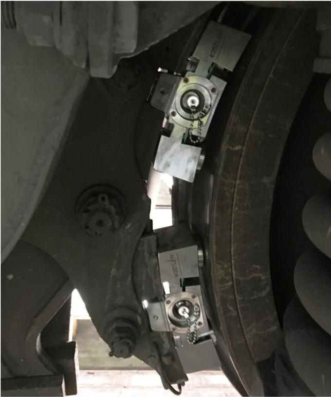
Abb. 3: Doppelklotzbremse mit zwei eingebauten Belagskraftsensoren Kistler Typ 9305A1B
