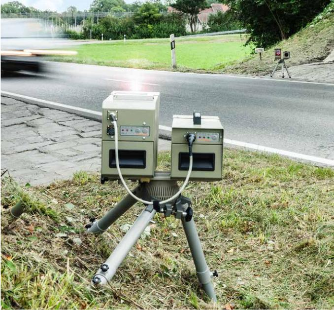
Überwachung beider Verkehrsrichtungen mit nur einem Messsystem und zwei unabhängigen Fotoeinheiten
