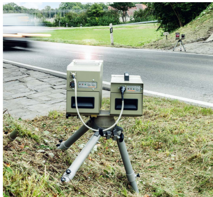
只需一台测速仪，配备两台独立的抓拍相机，即可监测双向行驶的车辆速度。
