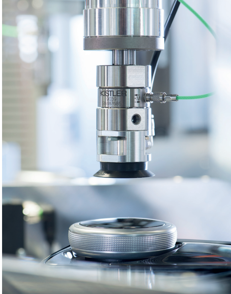
Haptik-Prüfung mittels piezoelektrischen Drehmomentsensor, Typ 9039.
