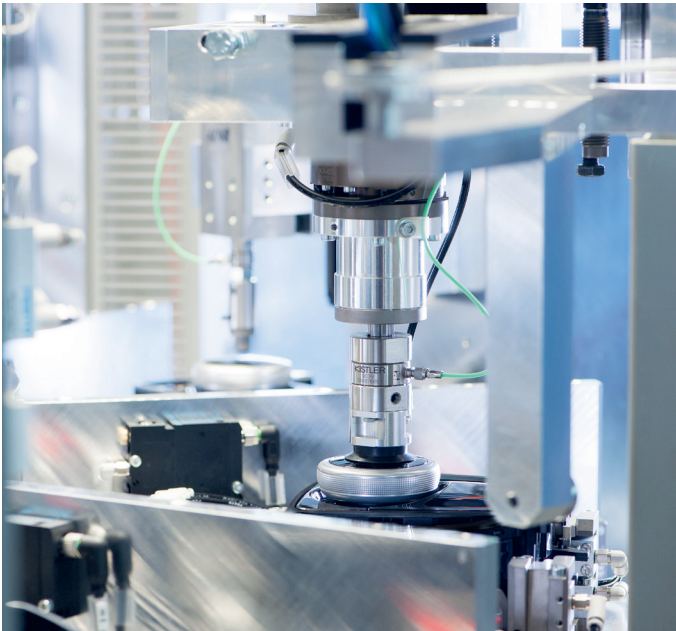
Der Drehmomentsensor liefert Daten mit einer Auflösung von bis zu 0.1 Nmm bei einer Drehgeschwindigkeit von bis zu 180 Grad/s.
