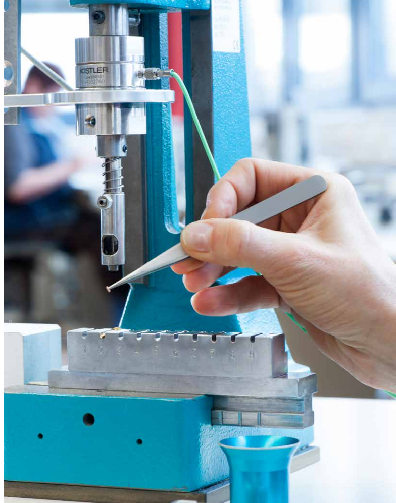
In der manuellen Fertigung für kleine Sonderauflagen wird die Qualitätsüberwachung direkt während dem Fügen vollzogen.
