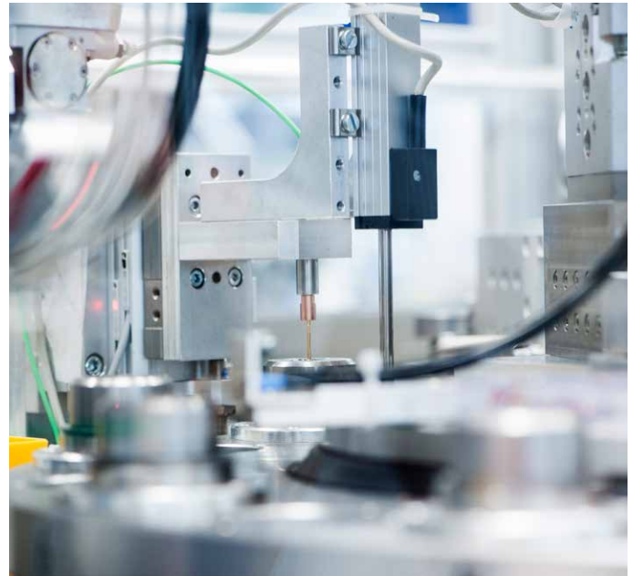
In der automatisierten Produktion wird als letzter Prozessschritt die Federkraft der Stifte überprüft.
