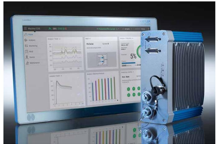
ComoNeo est le système de surveillance et pilotage des processus de moulage par injection. Il permet l'obtention de la meilleure répétabilité du processus et évalue la qualité des pièces livrées.
