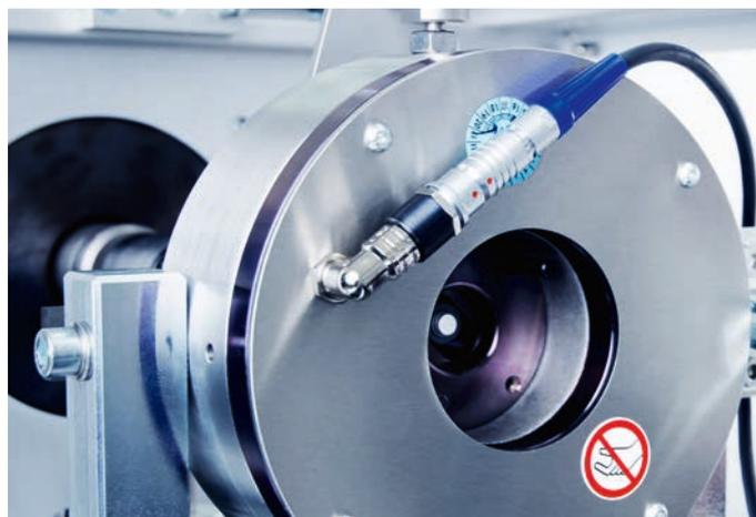
Sensor mit eingebautem Prüfling.
