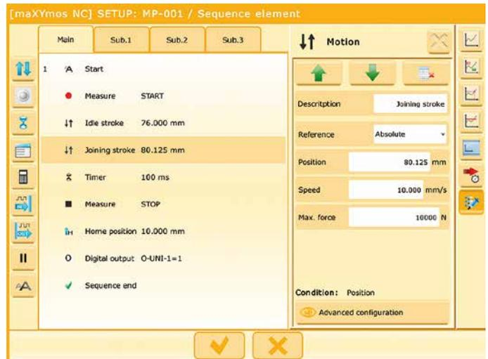
Kistler maXYmos NC steuert das NC-Fügemodul über die Servoverstärker für die Linear- und Drehbewegung durch die integrierte Ablaufsteuerung (Sequenzer Mode) an.
